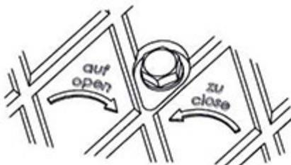
Pootočením šesthrannej skrutky vo vrchnej časti poklopu je ovládaná západka a detská poistka sa uzatvorí. Západka zapadne alebo sa uchytí do vnútornej hrany revízneho otvoru (bod 2.2.1). Maximálne je nutné ho pootočiť o jednu štvrtinu. Smer otočenia je znázornený na vrchnej strane poklopu. (auf/open = otvorené -- zu/close = zatvorené)
