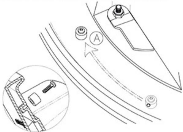
Obrázok vpravo znázorňuje detskú poistku poklopu v revíznej šachte v zatvorenom stave.
