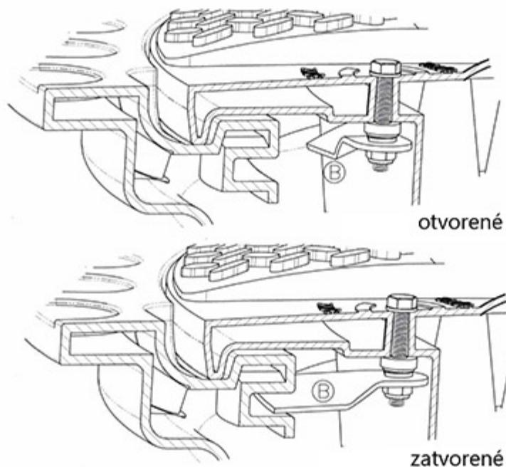
Aretačná skrutka zabráni neúmyselnému otočeniu poklopu. Pri osadení poklopu TopCover, treba dbať na to, aby aretačná skrutka bola zavedená do predvŕtaného otvoru (napr. v predlžovacom hrdle VS) a tým pádom poklop presne sadne na určené miesto.
